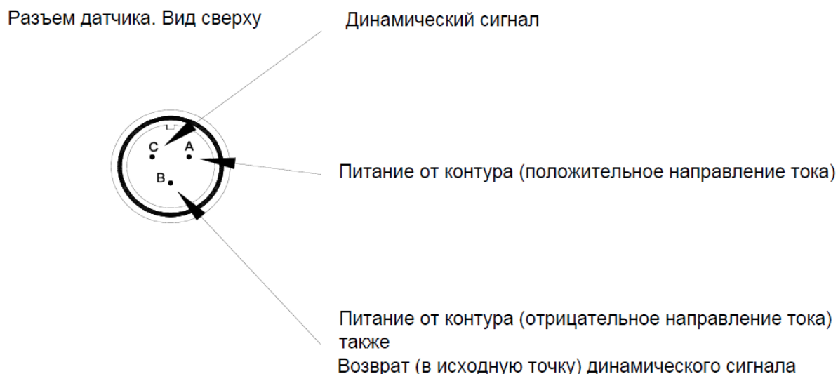
Рис. 3-3: Электропроводка динамического сигнала
